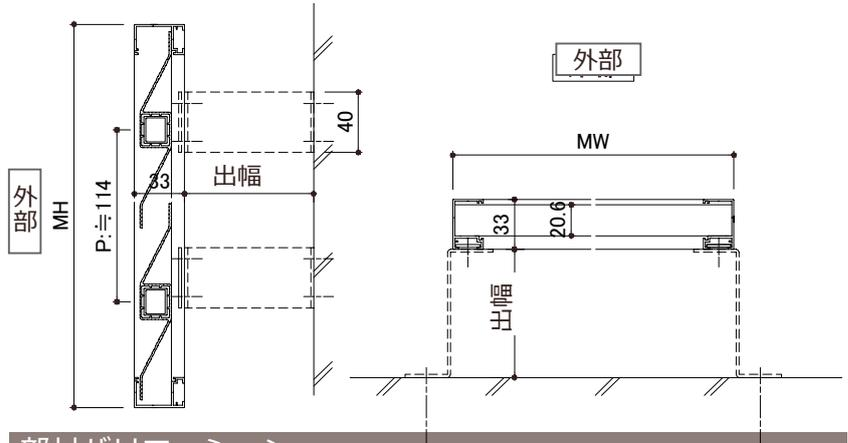
近隣対策で、プライバシーを守ります。視線は遮りますが、光と風は通しますので快適にご使用いただけます。ルーバー材にアルミ材を入れ補強することで、面格子としても利用可能です。
