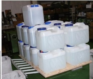
・羽根材は、ポリカーボネート製ですので、耐衝撃・耐候性に優れています。アルミ角材を入れることで、強度が上がり強風にも耐えられます。(340kg加重/パネル6枚 約1㎡)
