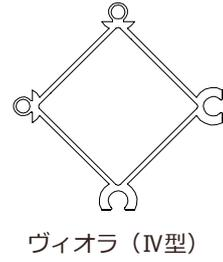
アルミ押し型材を 20 mm 巾にカットし、カット面を表にしてつないだ意匠性に優れた製品です。
